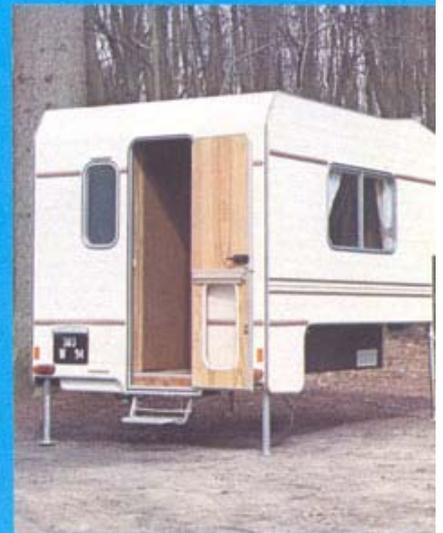
Azur c'est une solide construction traditionnelle sur plancher porteur, adapté à un système de levage 4 points permettant dépose et transport. L'isolation Styrofoam, entre revêtement Euromax prélaqué et panneau à face décorative. Le mobilier, les appareils ménagers, la dinette 4 personnes, un couchage 125 x 190 et un autre de 130 x 190 en font un HOME DE SÉJOUR à utilisations variées et économiques.
